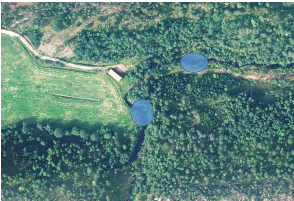
Figur 32. Anlegging av sedimentasjonsbassenger oppstrøms og nedstrøms traktorveikrysning, i skillet mellom elveavsnitt E og F.
