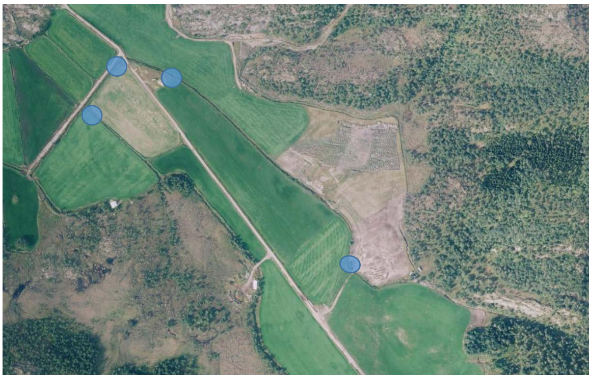
Figur 43. Flyfoto av elveavsnitt G2. Blå markeringer viser forslag til punkter i vassdragsområdet hvor det kan være aktuelt å etablere mindre fangdammer. Bassenger utformes i ulik størrelse; noe større i hovedvassdraget og mindre fangdammer knyttet til drenggrøfter (før samløp med hovedelva).
