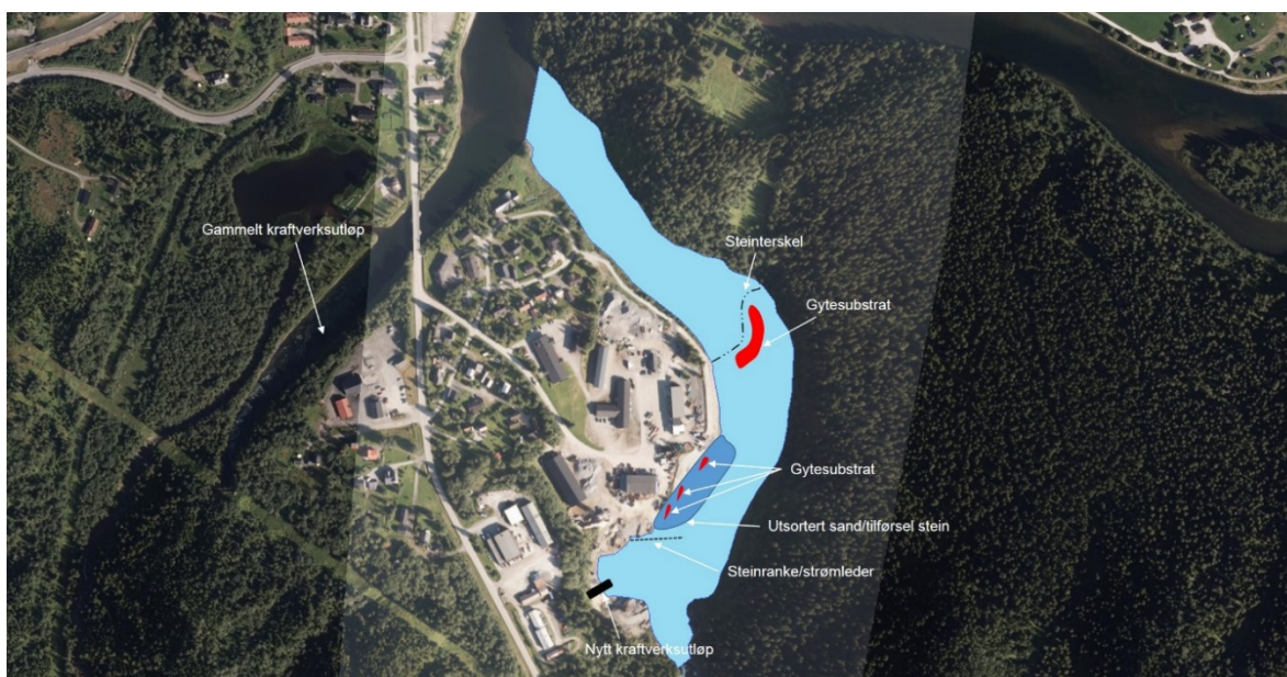
Figur 2. Prinsippskisse for arbeider knyttet til tiltaksområdet mellom nytt og gammel kraftverksutløp i Røssåga. Spredt utlegg av steinblokk nedstrøms steinterskel er ikke tegnet inn. Skissen er hentet fra Kanstad-Hanssen et al. (2015).
