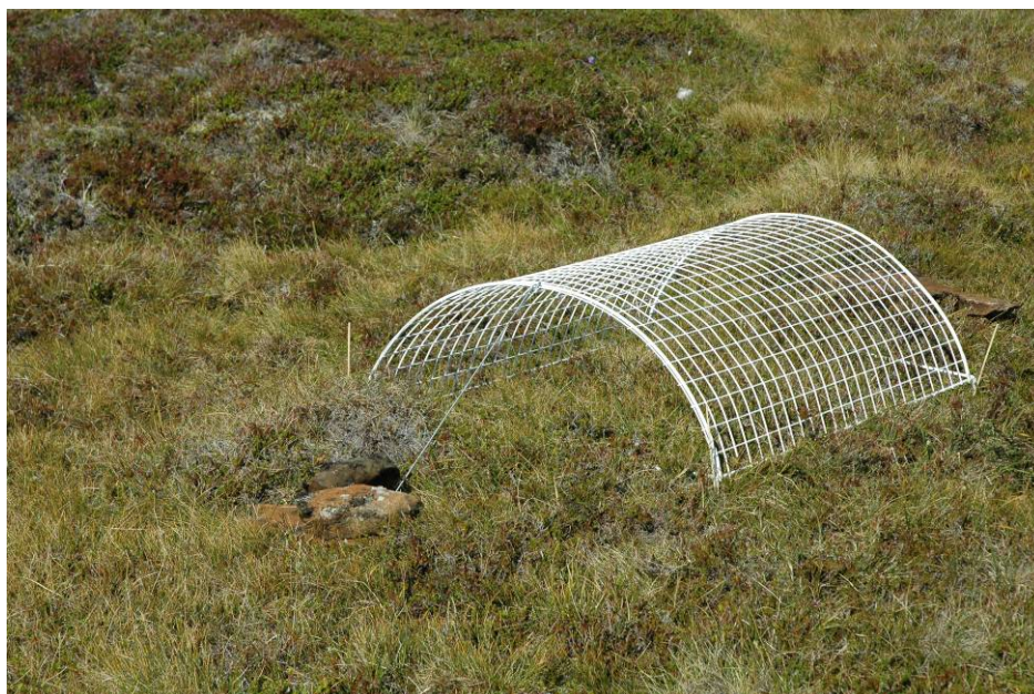
Figur 6. Beskyttelsesskjerm mot reinbeite benyttet ved plantevekstmålinger.
