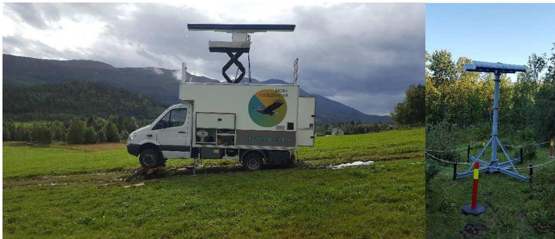
Figur 6. Den mobile fugleradaren med S-bånd-radaren på taket (venstre) og FMCW-radaren plassert på bakken like ved (høyre) klar til bruk i Osen, Kleive. Foto: Bård G. Stokke ©.
