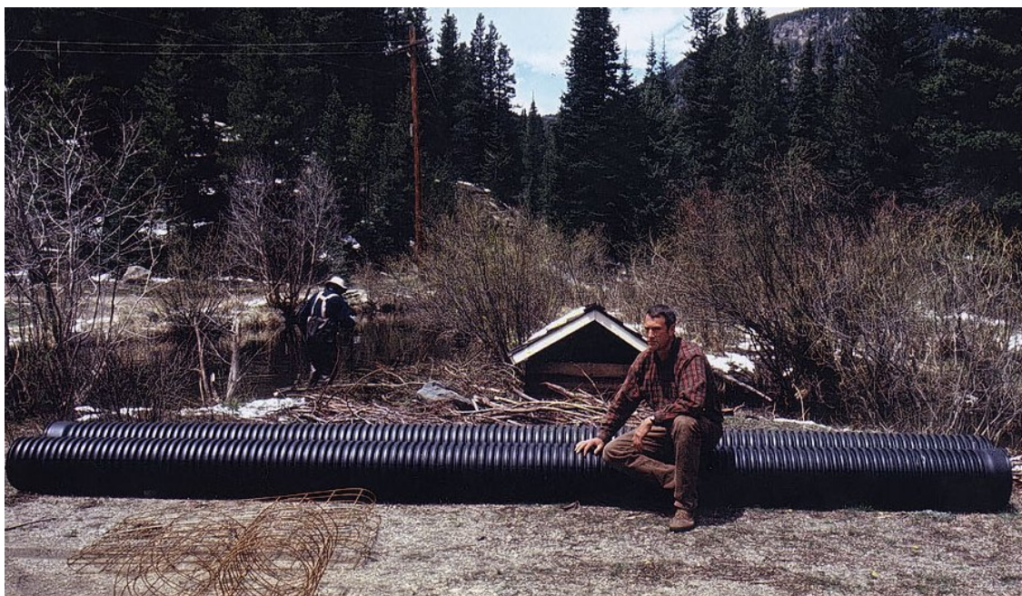
Figur 13.1 Polyetelen (PE) rør. For bruk i drenering må rørene perforeres på toppen og bunnen av hver korrugering, og små hull bores rett igjennom på toppen av og til (se tekst). Foto: S. Lisle
