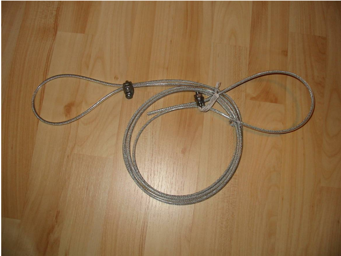
Figur 7.5. Stålwire med plaststrømpe og wire-klyper. Foto: D. Halley
