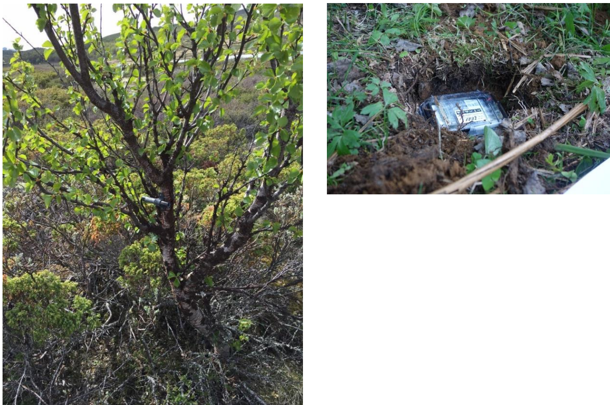
Figur 6. Personteller montert oppe i ei bjørk langs et smalt punkt på stien registrerer infrarød varmestråling (til venstre). Sykkelteller, som registrerer metall, graves ned ved eller i stien (til høyre).
