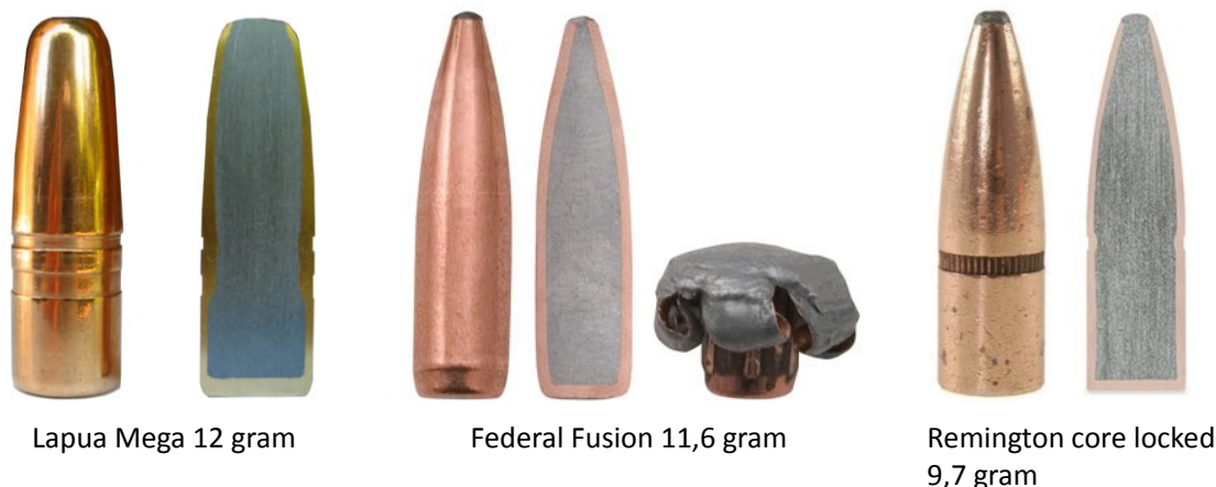
Figur 4. Helbilde og snitt av de tre anvendte jaktkulene Lapua Mega, Federal Fusion og Remington Core Locked. Alle kulekonstruksjonene er basert på en deformerbare blykjerner som er omsluttet av en kobbermantel. Lapua Mega og Remington Core Locked har mekanisk låsing av blykjernen for å unngå mantelseparasjon. Det vil si at mantelen har en fortykning (Lapua Mega) som skal hindre blykjernen fra å trekkes ut av mantelen når ekspansjonen skjer. Remington søker å oppnå det samme ved å presse en cannellure (rille) inn i kulens mantel. Federal Fusion har en annen tilnærming ved at blykjernen er loddet til kobbermantelen for å hindre at de to delene separeres under ekspansjonen. Ekspansjonen skjer fordi trykkøkningen (stagnasjonstrykket) i kulespissen ved anslag i dyrekroppen overskrider flytegrensen til blyet, som derfor opptrer som en inkompressibel veske og sprenger mantelen. Mantelen vil da vrenge bakover samtidig som blyet «flyter» utover og formes etter den stivere mantelen. Etter endt ekspansjon får kulene en typisk sopplignende fasong som vist for Federal Fusion.
