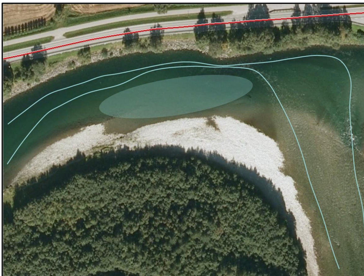
Figur 3. I elvesvinger med høy vannhastighet vil observatørene ofte bli presset sammen i ytersving (svømmerute indikert med lyseblå linjer), noe som kan medføre at store deler av elvetverrsnittet ikke blir undersøkt (indikert som skravert område).
