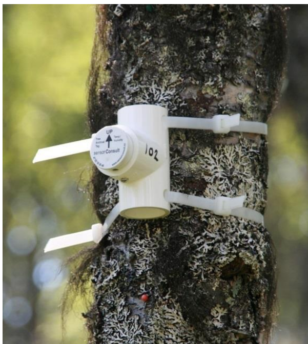
Figur 11. Logger for måling av lufttemperatur og -fuktighet montert på overvåkingstre i Møsvatn i 2012. Foto: M. Evju, NINA.
