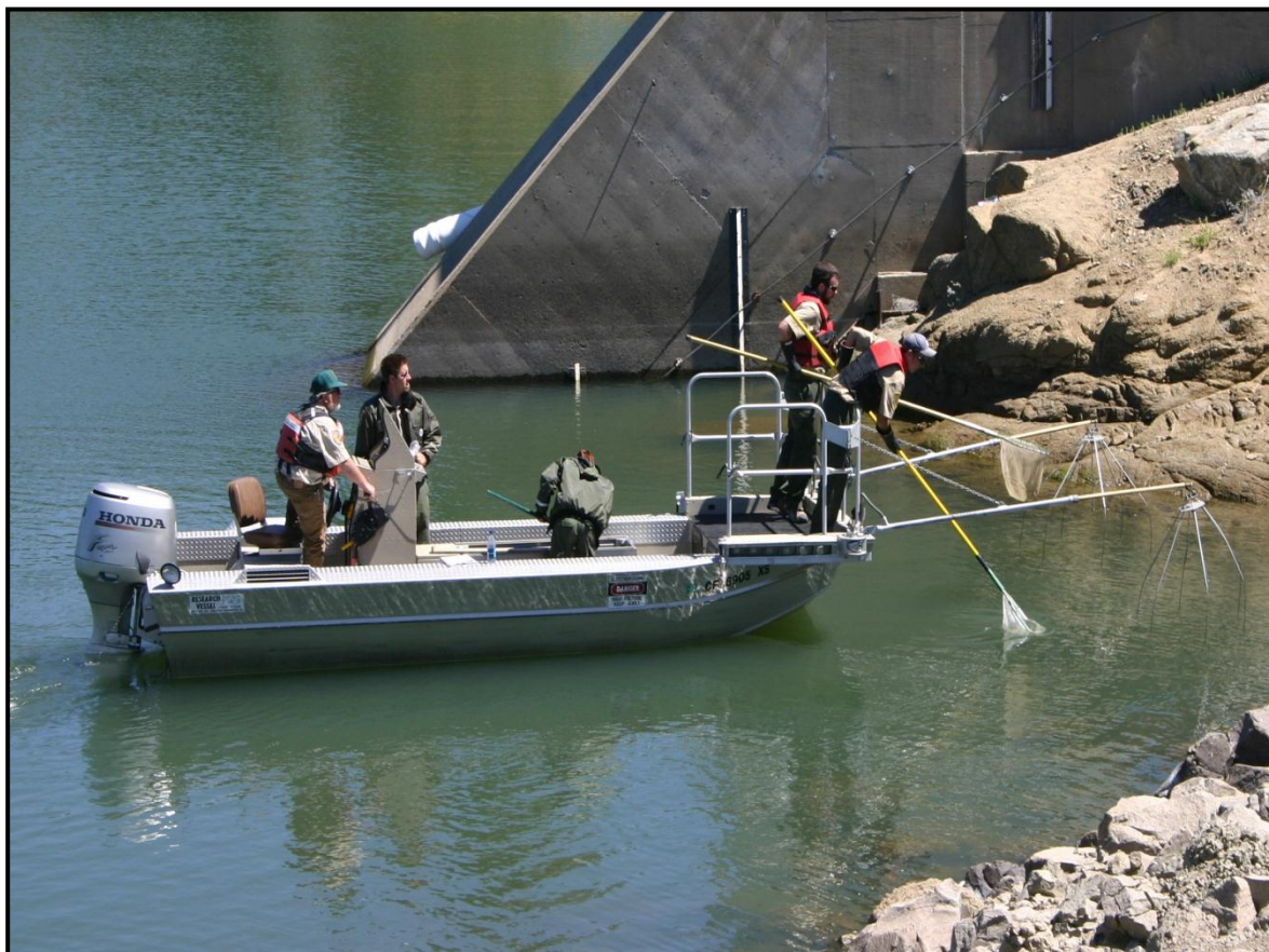
Bilde 3. Elektrisk båtfiske et utviklet av et amerikansk firma ( www.smithroot.com ) for fiskebiologiske undersøkelser i større elver og strandsonen av innsjøer. Metoden er spesielt mye benyttet i regulerte elver i USA slik som på dette bildet. Foto: Jarle Steinkjer.
