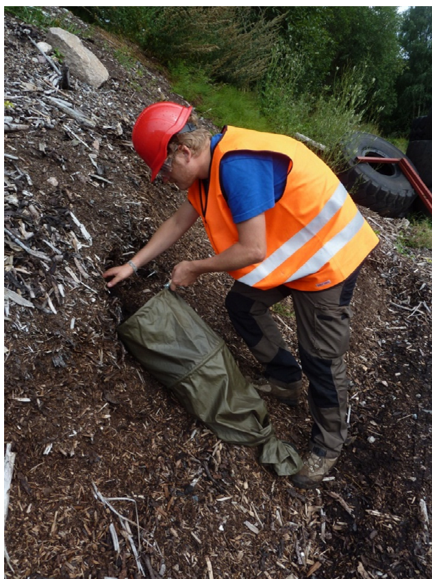
Figur 5.6. Sålding av prøver. Materialet ble såldet i en såld med maskevidde 6x6mm og totalt åtte prøver á 4 liter ble samlet inn fra barkhauger på området.
