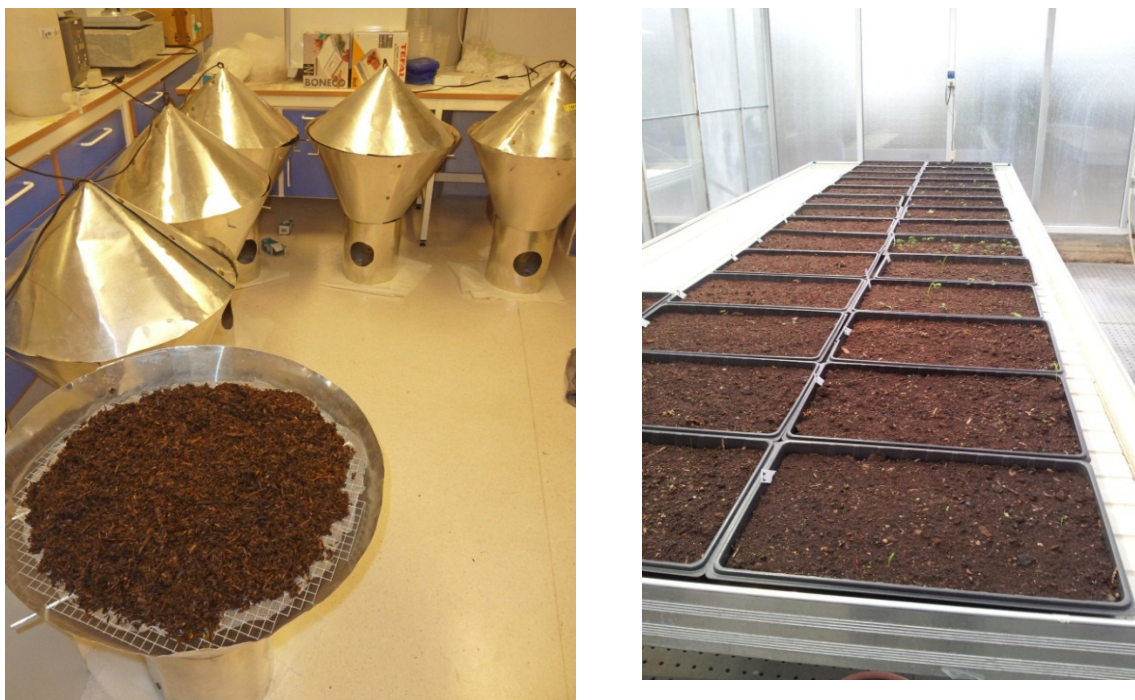
Figur 5.4 Utdriving av invertebrater fra barkprøver i Berlesetrakter på lab (venstre) og dyrking av frøbank fra de samme barkprøvene i fytotron (høyre).
