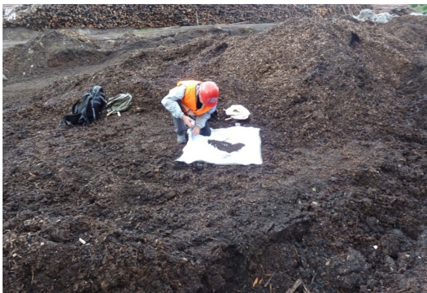
Figur 5.8. Manuell undersøkelse av flis/jord. Sådet materiale ble spredt ut på en hvit duk, og invertebrater ble samlet opp.
