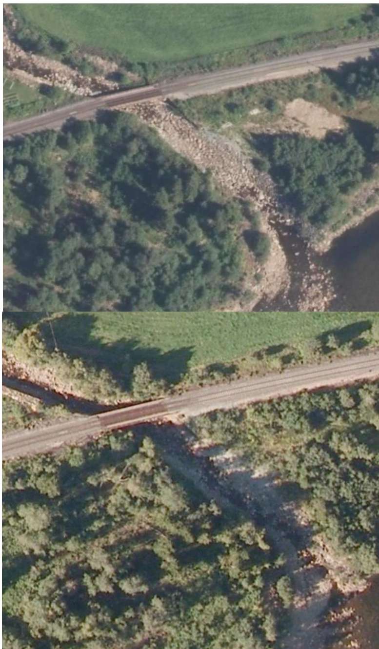
Figur 94. Flyfoto fra 2014 (øverst) som viser at Sevilla (på lav vannføring) går under nylig utlagt storstein og blokk, på en strekning på om lag 30-40 meter. Flyfoto fra samme strekning med lik vannføring i 2010 (nederst) viser full vannkontinuitet før sikringstiltaket ble gjennomført. Flyfoto fra http://kart.finn.no/ .
