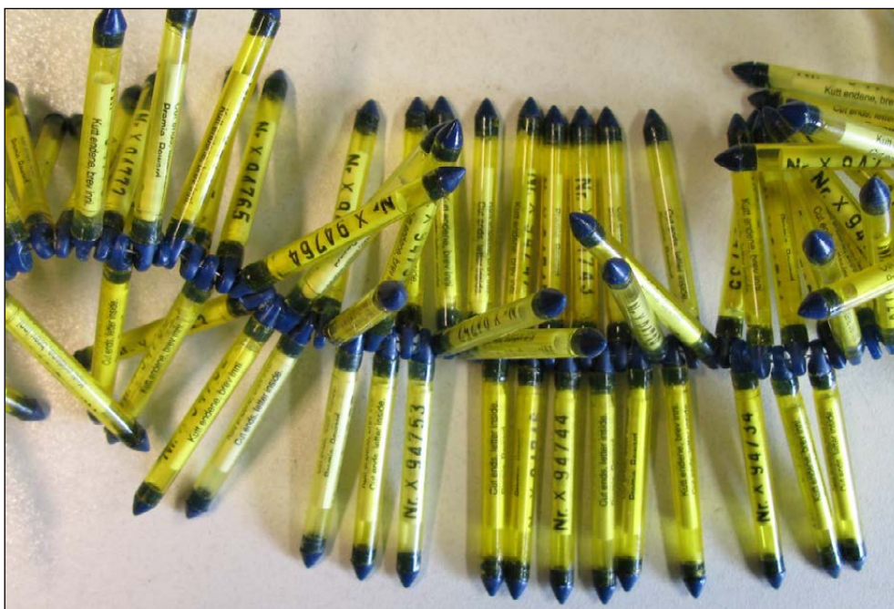
Lea-merker klare til oppbinding for bruk til merking av voksen laks. Foto: Knut Aanestad Bergesen
