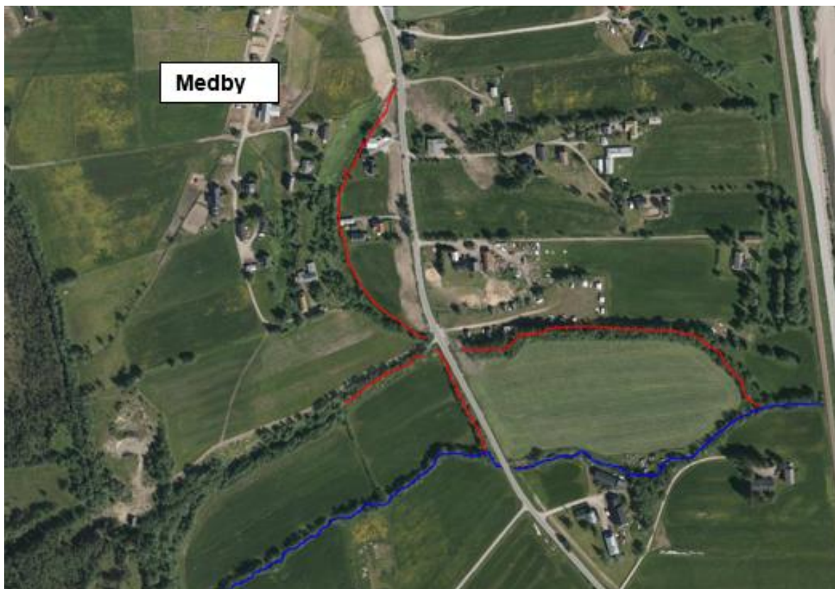
Figur 21. Problemtilførsler av jernholdig vann via grøfter og tilsig (rødt) til Oksielva (blått).
