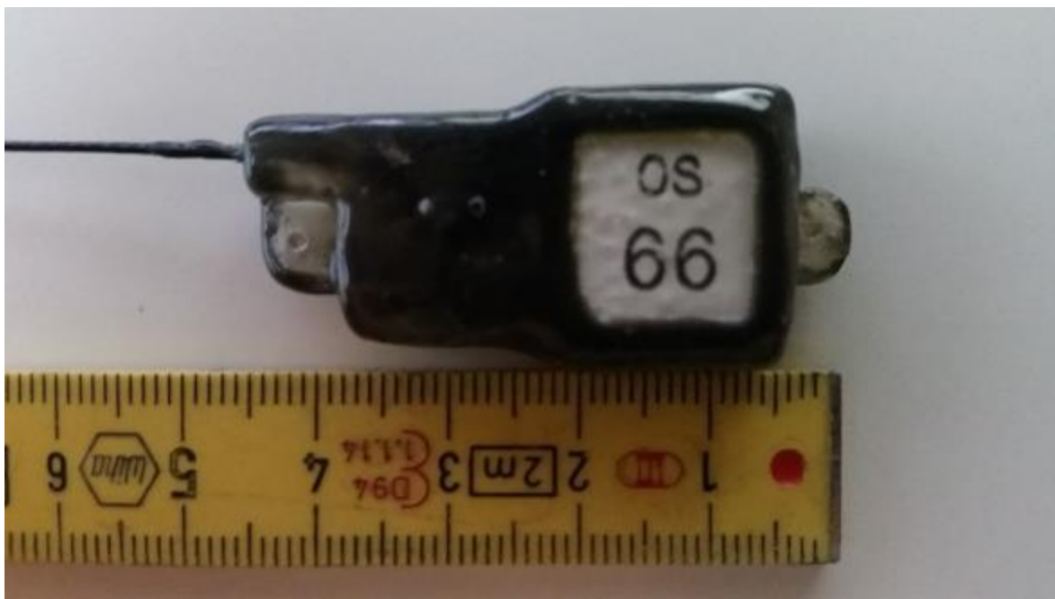
Bilde 3. En av radiosenderen brukt til merking av laks i Osenvassdraget. Alle senderne var individuelt merket med «OS» og et eget nummer. Foto: Eva M. Ulvan, NINA
