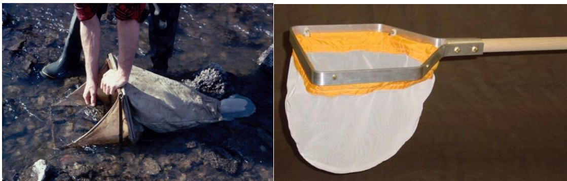
Figur 3.6.1. Surbersamplers (til venstre) og sparkehåv finnes i flere utgaver.
