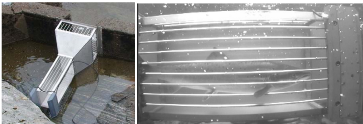
Figur 4 Videoovervåking i fisketrapp. Bildet til venstre viser kalv med målekammer og optisk sensor/utløser. Bildet til høyre viser en villaks inne i målekammeret.
