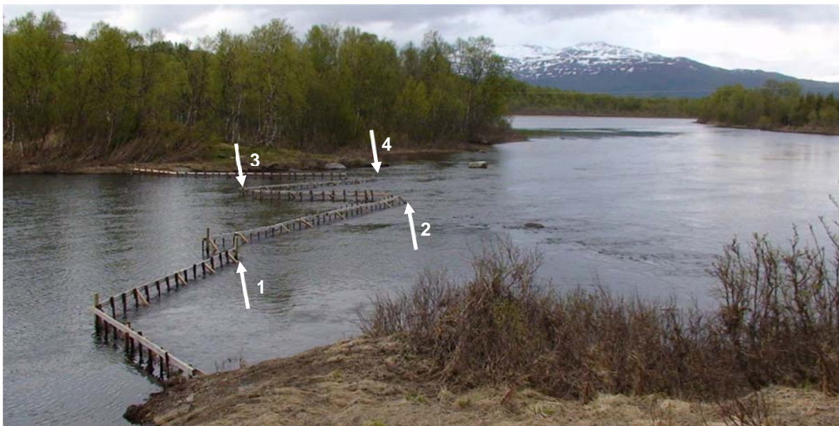
Figur 12 Overvåkingslokaliteten i Laukhellevassdraget (Lakselva), Senja, Troms. Pilene viser åpningene i ledeveggene og plasseringen av videokamera (1-4). Fiskefellene ble satt ut på oversiden av de to åpningene (nr. 3 og 4) som er lengst bort i bildet.
